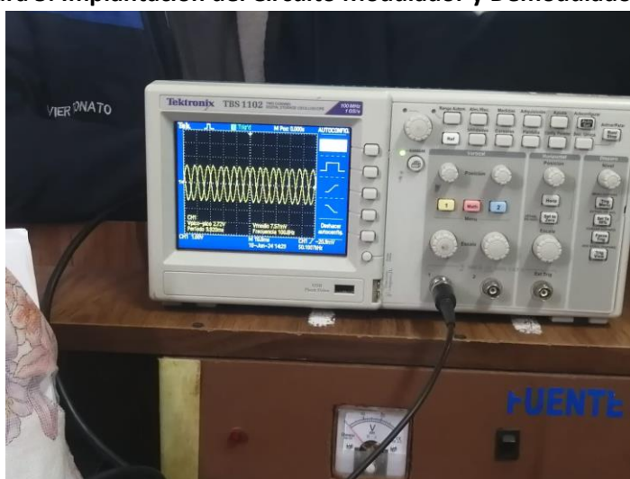
Figura 6. Señal del Circuito Modulador y Demodulador AM
